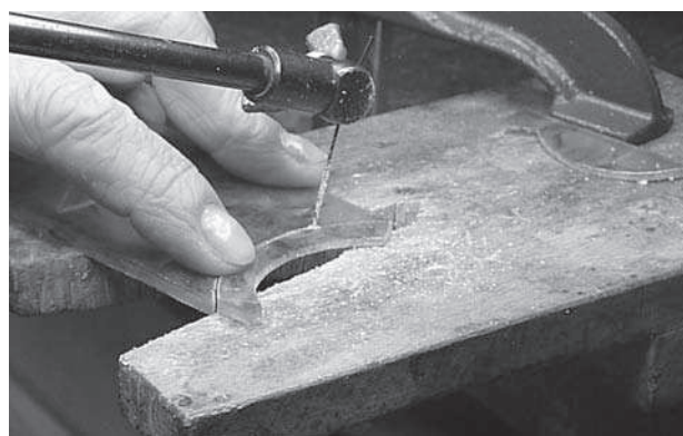
Figura 17. Detalle del segueteado de una pieza de resina para poder adaptarla a una de las lagunas
